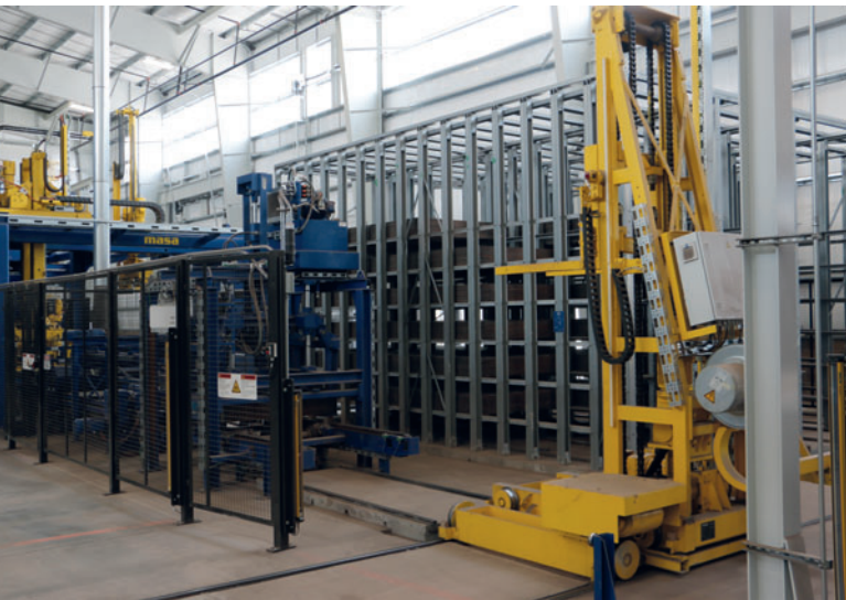
Das Puffersystem für ca. 2.000 Produktionspaletten mit Speicherregal und Transportwagen
