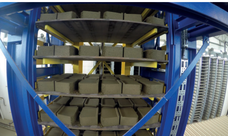
Kleine Stützmauer-Elemente sind nur eins der vielfältigen Produkte (Nasssplitt-Produkte), die mit der Steinfertigungsanlage hergestellt werden können.
