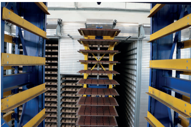
Frischproduzierte Produkte bei der Abgabe an das Hubgerüst
