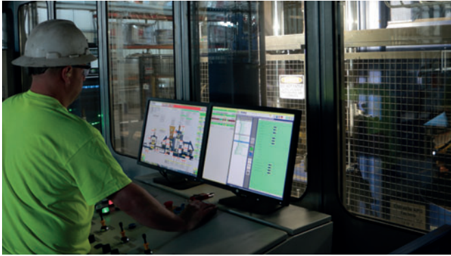
Ein Maschinenführer bedient auf der Produktionsseite über ein Masa-Steuerpult die Masa XL 9.1.
