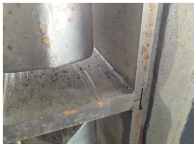
Рис. 4: Минимальный износ по углам на форме для пустотелых блоков Kobra с закалыванием класса carbo
