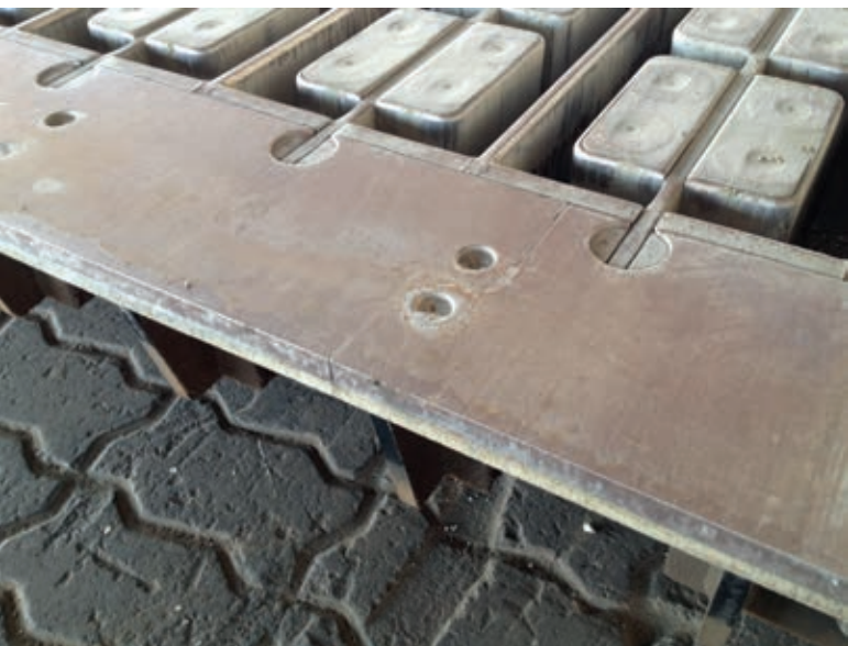
Рис. 1: Сегментные защитные пластины carbo для упрощения замены изнашиваемых деталей
