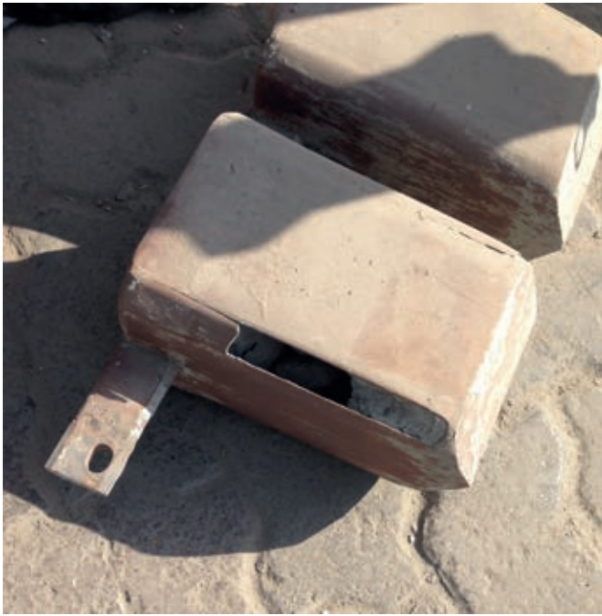
Рис. 5: Азотированный сердечник полностью изношен
