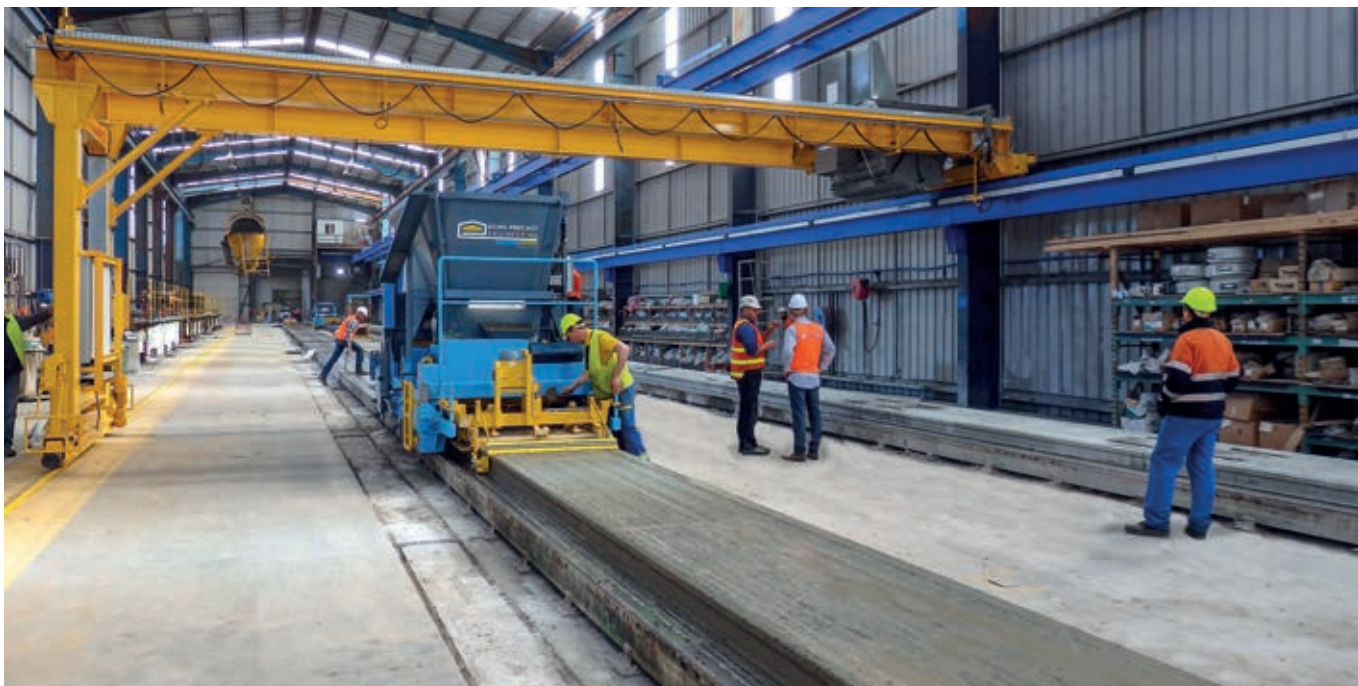
С помощью универсального слипформера компания Westkon Precast выпускает преднапряженные перекрытия высотой от 20 до 50 см
