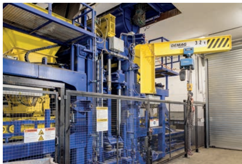
Основные компоненты XL 9.1: вибрационный блок между загрузочными модулями для опорного и облицовочного бетона
