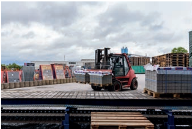
Блоки хранятся на деревянных паллетах с защитной пленкой
