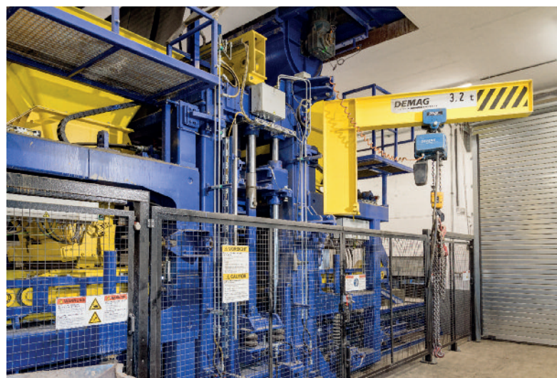
Najważniejsze elementy wibroprasy Masa XL 9.1: zasypy mieszanki konstrukcyjnej i licowej wraz ze znajdującą się między nimi jednostką wibracyjną.
