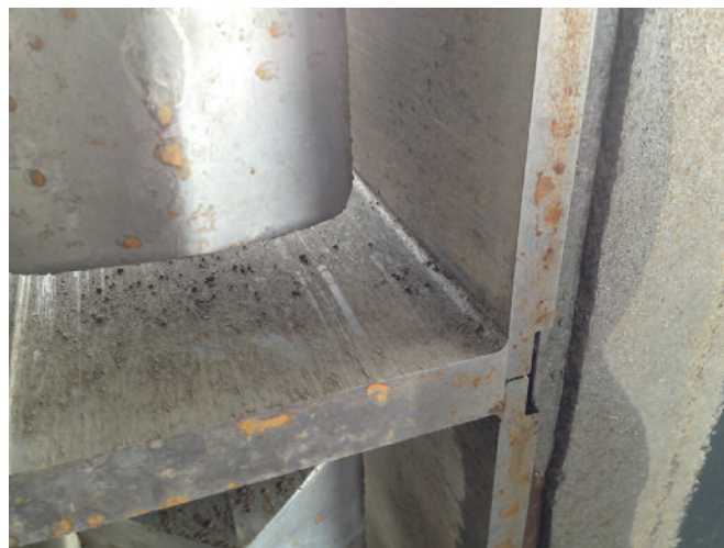
4. Minimalnie starte narożniki formy Kobra do pustaków w twardości carbo.
