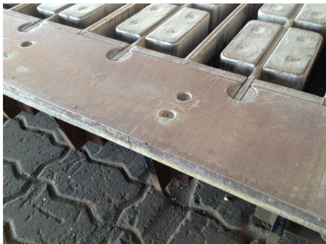
1. Stemple segmentowe ułatwiające wymianę zużytych elementów.
