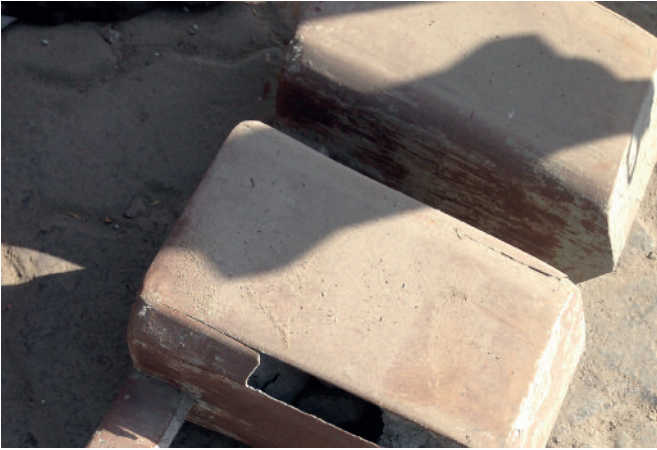
5. Rdzeń poddany nityfikacji, całkowite zużycie.
