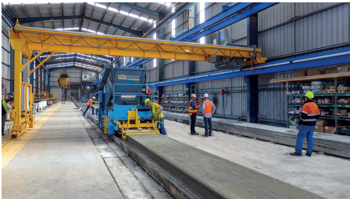
Con la vibrofinitrice universale la Westkon Precast produce solai alveolari precompressi di 20 - 50 cm di altezza.
