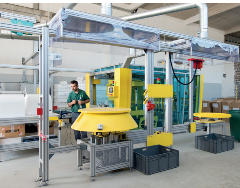
La tecnica di produzione convalidata a livello mondiale è ora in uso presso Beton Kemmler - nell'illustrazione, la tecnica di taglio EPS
