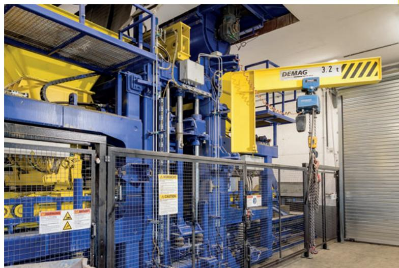
I componenti principali della XL 9.1: l'elemento di compattazione è collocato tra i due elementi di caricamento per il calcestruzzo per lo strato interno e quello di rivestimento.
