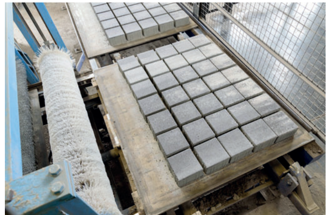
Après le temps passé dans la chambre de séchage, les blocs sont encore une fois brossés et sont alors prêts pour la palettisation.
