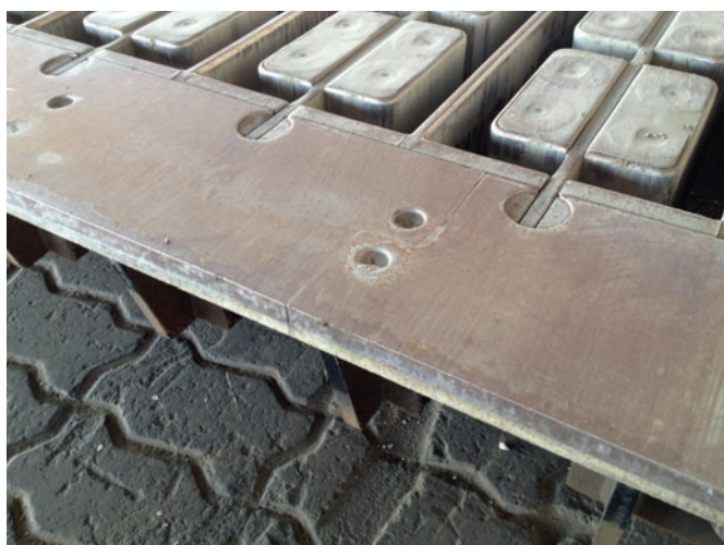
Figure 1 : Tôles d'usure segmentées pour le remplacement aisé des pièces d'usure
