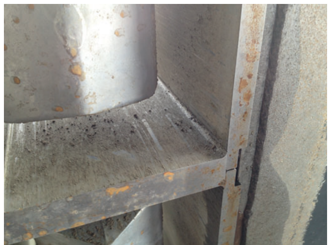
Figure 4 : Usure minime des arêtes sur un moule pour blocs Kobra de dureté carbo
