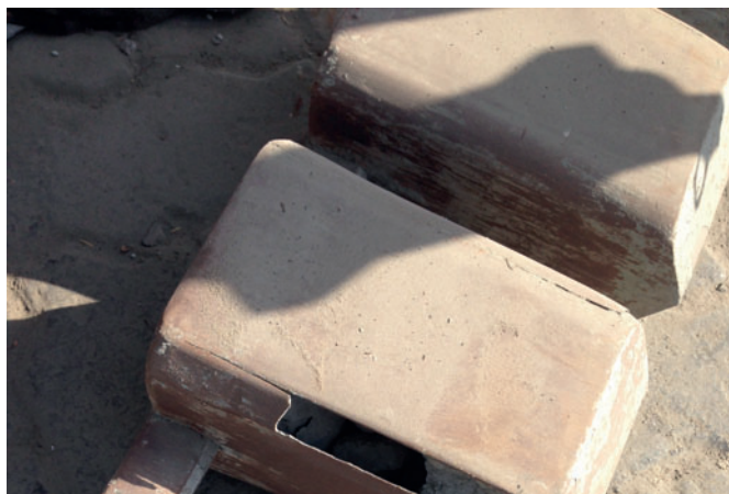
Figure 5 : Noyau nitruré, usure totale
