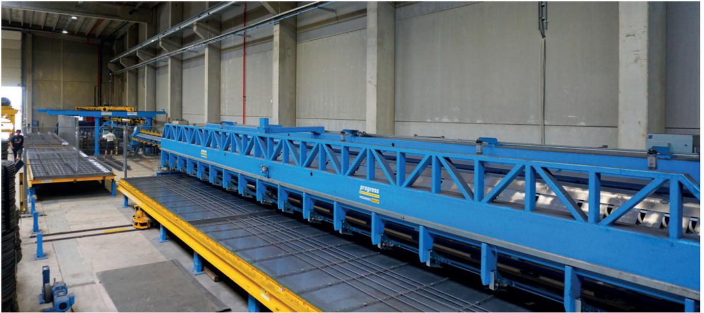
*Pour l'introduction automatique des barres longitudinales, la palette se déplace elle-même transversalement sous la sortie de la machine de dressage et de découpage MSR nouvellement installée.*
