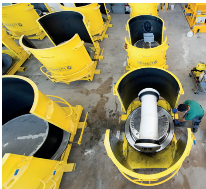
Les cunettes EPS (négatifs de moules) sont placées dans des moules faciles d'utilisation. Le béton durcit dans le moule pendant la nuit.
