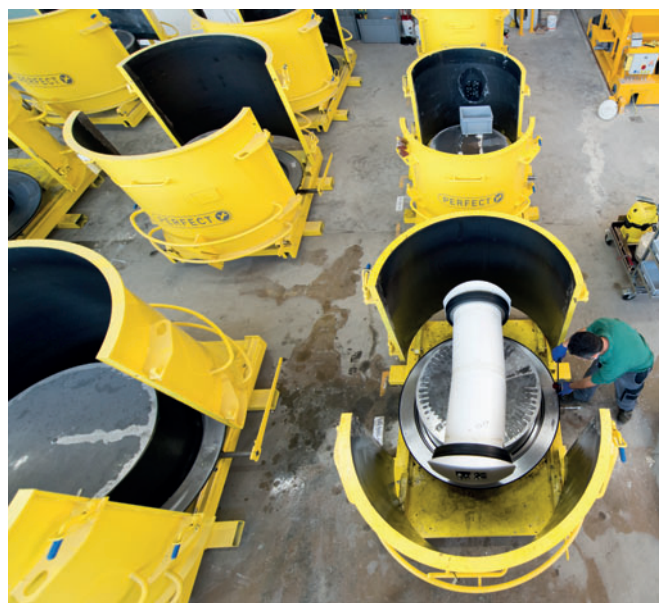
Los canales negativos de EPS se introducen en moldes fáciles de manipular y se producen en un día
