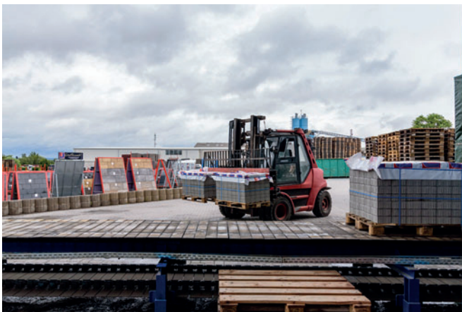
Los adoquines son almacenados sobre paletas de madera y recubiertos con una lámina de protección.
