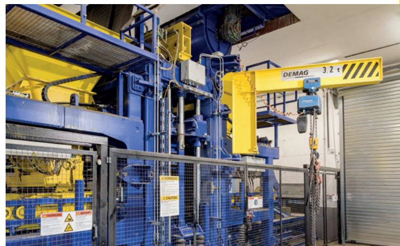
Los componentes principales de la XL 9.1: La unidad de compactación se encuentra entre ambas unidades de llenado para el hormigón monocapa y bicapa.
