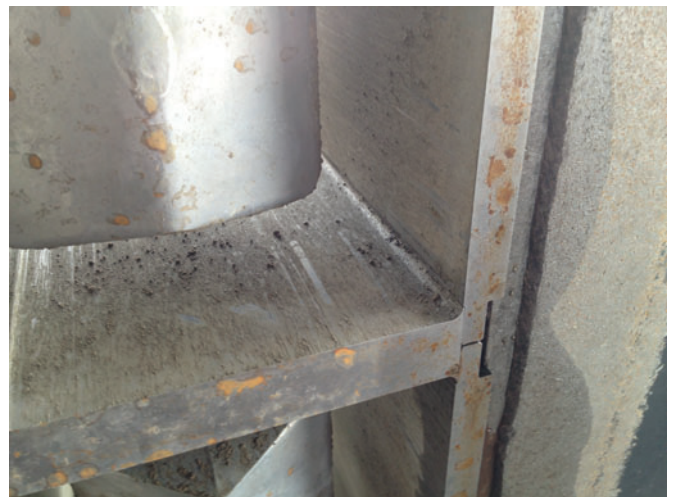
Figura 4: Desgaste mínimo en las esquinas en el molde para bloques de Kobra con el temple carbo
