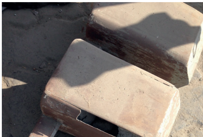
Figura 5: Noyo nitrurado, desgaste completo
