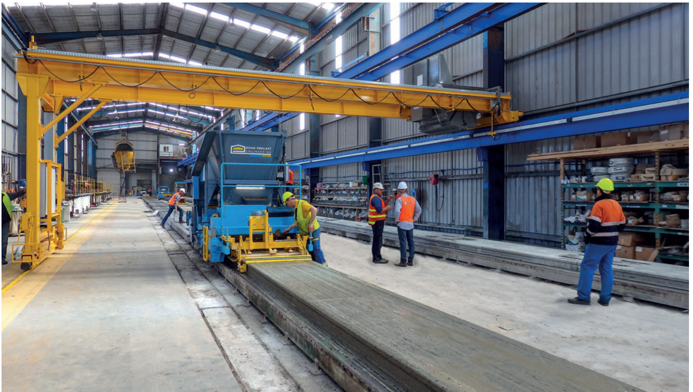
Con la máquina deslizante universal, Westkon Precast fabrica placas alveolares pretensadas con alturas de 20 cm a 50 cm
