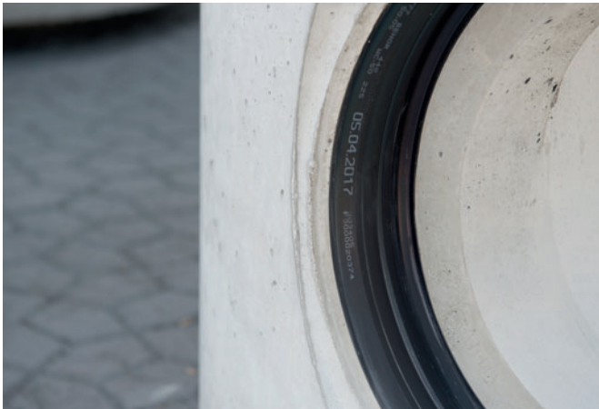
Die feste Verbindung der integrierten Dichtung mit dem Beton Schachtunterteil ist durch die Fertigung in einem Guss mit SVB sichergestellt.
