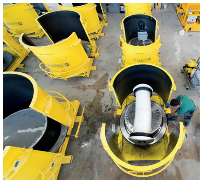
In einfach zu bedienenden Gießformen werden die Negativ-EPS-Gerinne eingelegt und über Nacht schalungserhärten gefertigt.
