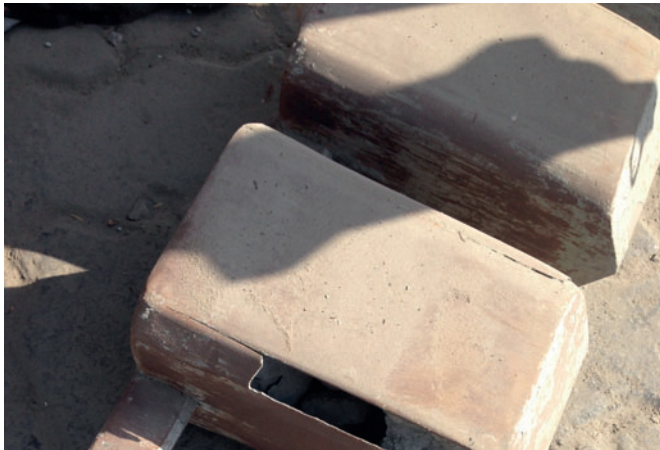
Bild 5: Nitrierter Kern, Komplettverschleiß
