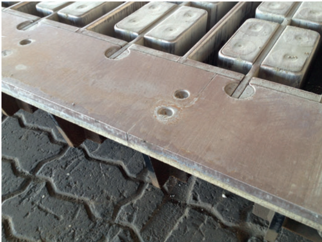
Bild 1: Segmentierte Deckbleche zum vereinfachten Austausch von Verschleißteilen
