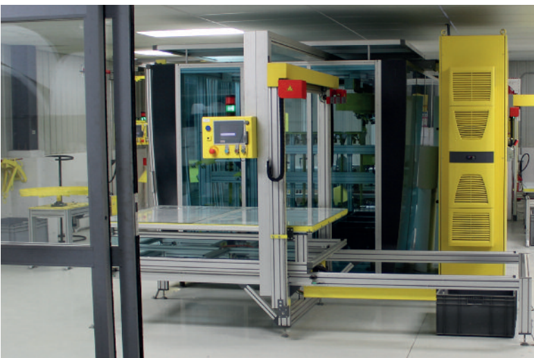
Serce systemu produkcyjnego Perfect: centrum przygotowania negatywów kinet z wycinarkami 2D oraz 3D.
