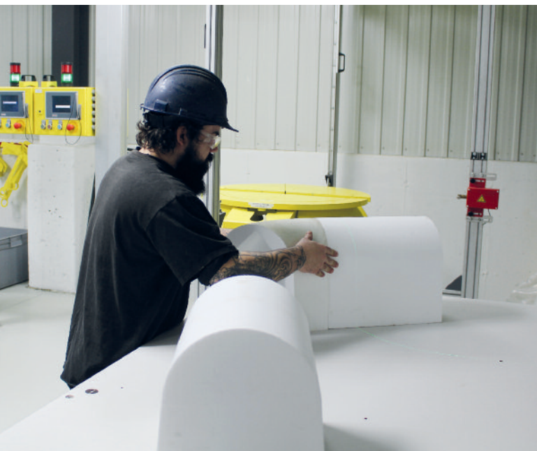
Wskaźnik laserowy wyświetla przebiegi kanałów na stole montażowym, co zapewnia poprawne połączenie kształtek.
