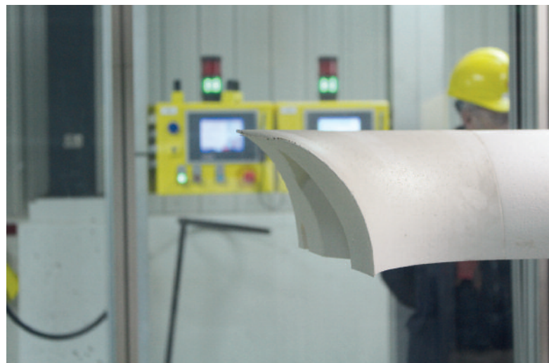
Wycinarka 3D wykonuje dokładne cięcie umożliwiające integrację dolotów głównego kanału.
