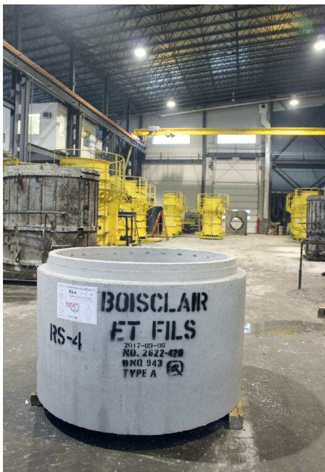
Gotowa podstawa studni Perfect przed wywozem na zewnętrzny magazyn.
