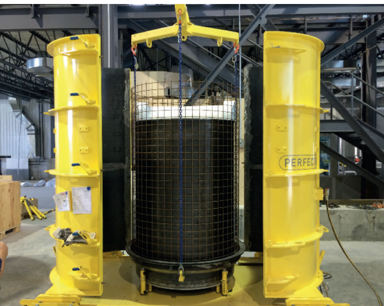
W pełni wyposażona forma, uwzględnia zbrojenia ścianki...
