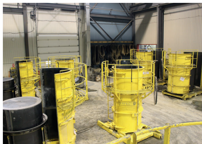
Parco di stampi per la produzione dei fondi per pozzetti in calcestruzzo Perfect
