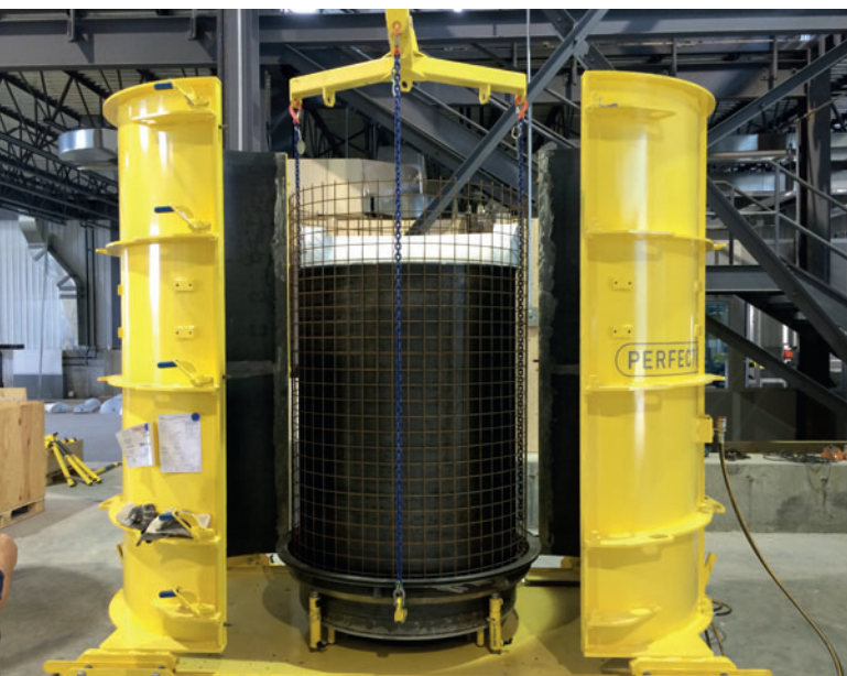
Stampo finito con armatura della parete del pozzetto...
