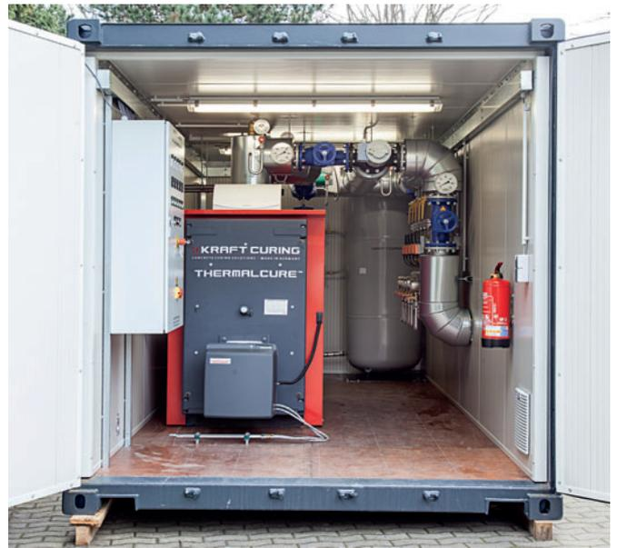
Le système de durcissement accéléré du béton ThermalCure est livré prémonté, prêtubé et précâblé dans un conteneur maritime de 20 pieds, isolé, ventilé et éclairé, afin de permettre une mise en place immédiate et une mise en service rapide.
