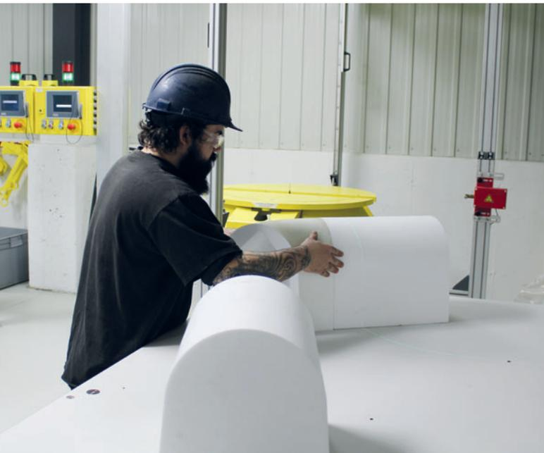
*Un laser contrôle le positionnement sur-mesure des différentes pièces à l'aide de la table d'usinage sur laquelle est constamment indiqué l'ensemble des lignes du radier du fond de regard.*
