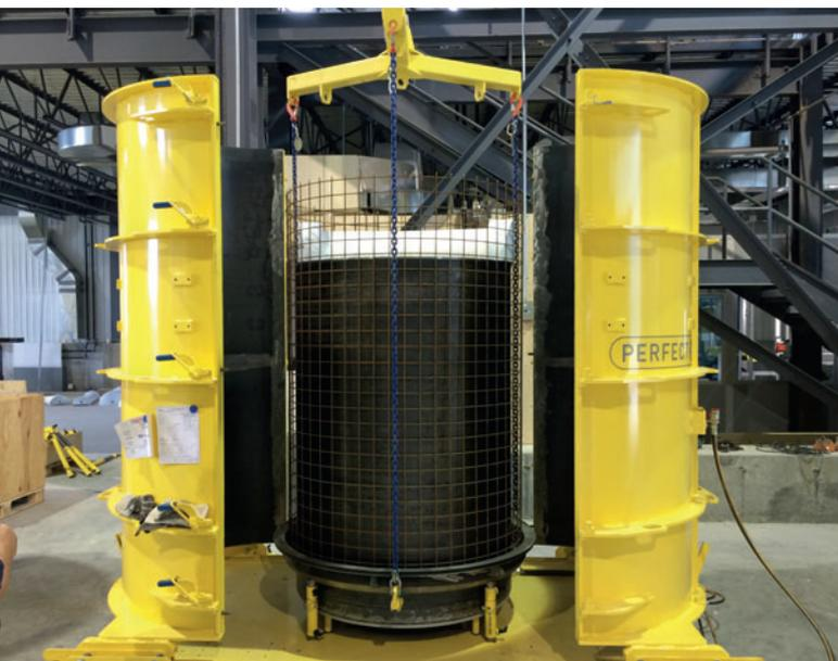
*Moule équipé avec armature pour la paroi ...*
