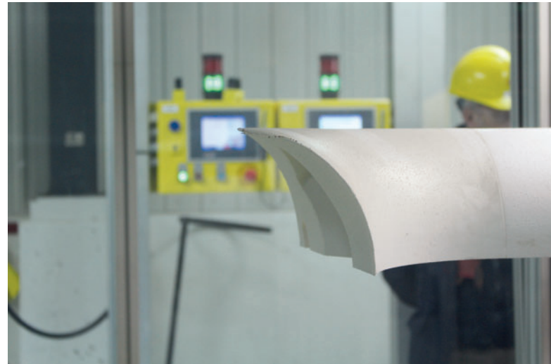
La sierra de 3D destinada al corte exacto del cuerpo negativo para los canales laterales.
