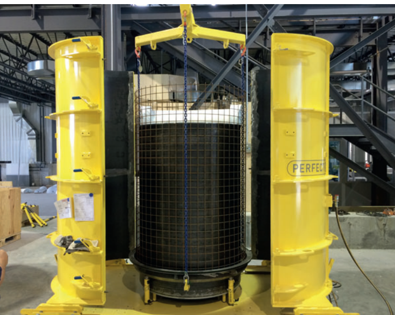
Molde totalmente equipado con pared de pozo ...
