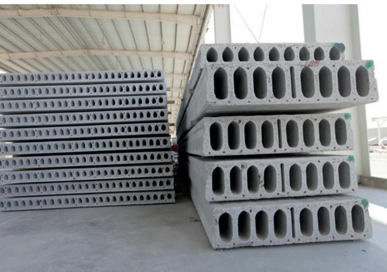
*Hi-Tech produziert Spannbetonfertigteildecken mit unterschiedlichen Querschnitten, einschließlich unterschiedlicher Breiten zwecks optimaler Montage, oder stärkere Wandungen für größere Spannweiten, damit den Anforderungen der Kunden bestmöglich Rechnung getragen wird.*
