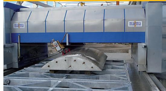
"Bellacrete" ist die Maschine von Maema zur Bearbeitung von Wandelementen, mit der auf glatten oder gekrümmten Elementen Folgendes realisiert werden kann:
