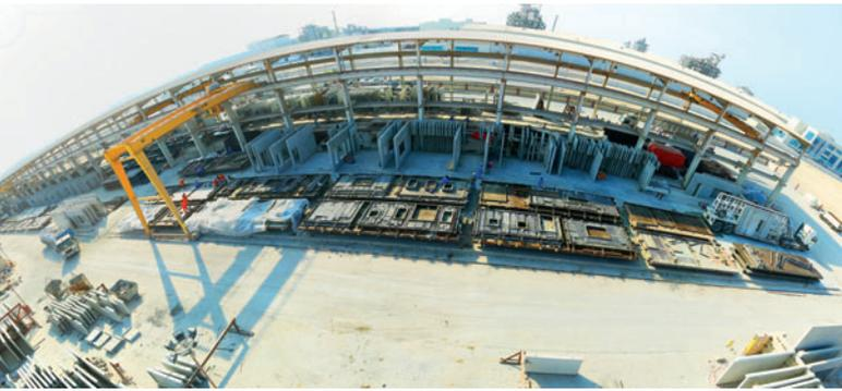
*Blick von oben auf einen Teil des Bereichs der Hi-Tech-Kipp-tischfertigung und des Lagerplatzes für vorgefertigte Wandplatten. Der Produktionsbereich für Spannbetonfertigteildecken befindet sich im überdachten Bereich des Werks.*
