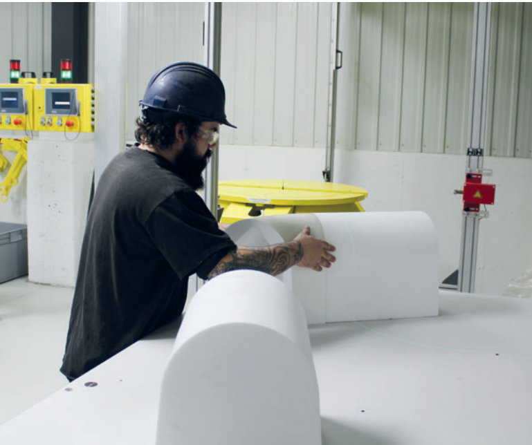
Für die Kontrolle der passgenauen Positionierung der Einzelteile sorgt ein Laser über dem Arbeitstisch, der alle Sohllinien des Schachtes kontinuierlich auf dem Tisch anzeigt.
