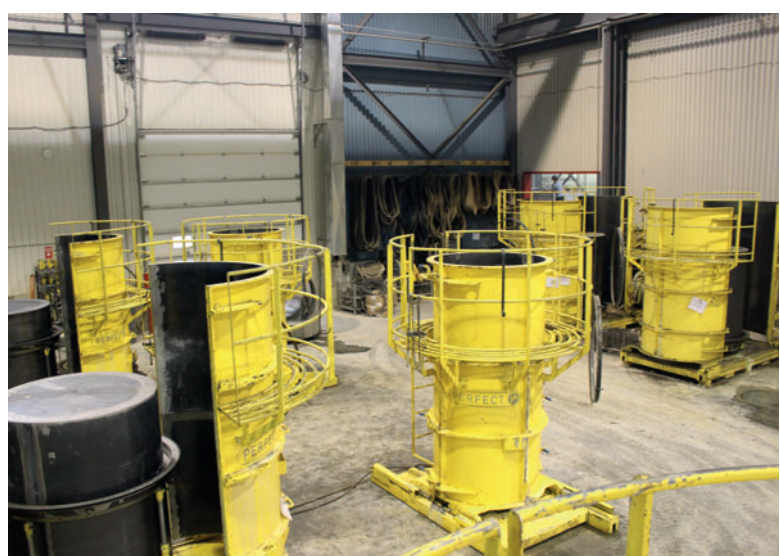
Formenpark für die Produktion der Perfect-Betonschachtunterteile
