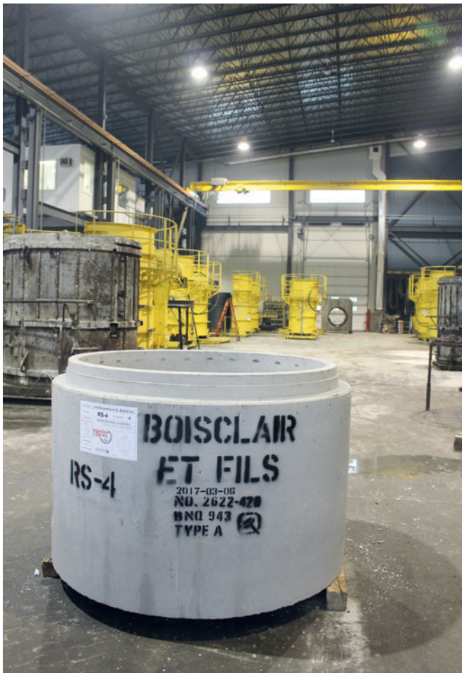
Fertiges Perfect-Betonschachtunterteil vor dem Abtransport in das Außenlager
