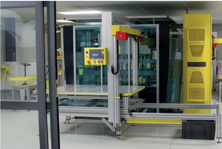
Das Herz der Perfect-Betonschachtunterteilerfertigung: Das Schneidezentrum mit 2D- und 3D-Sägen
