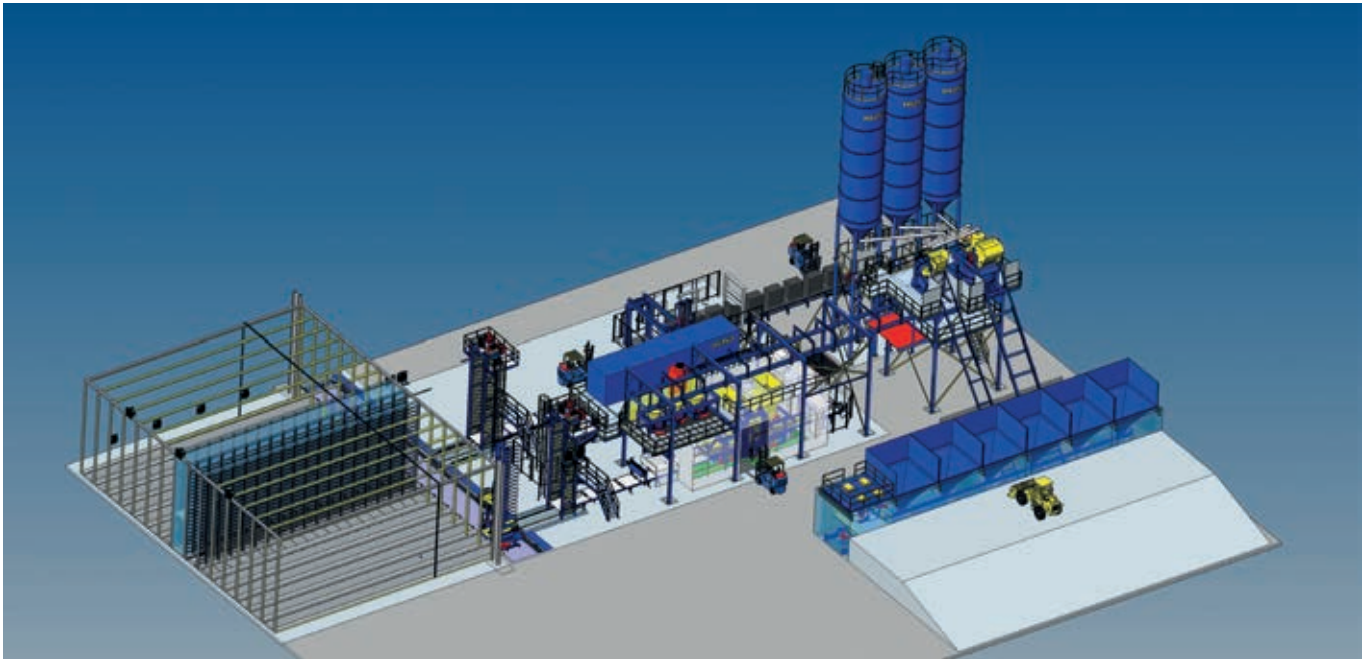
Рис. 4: Конструкция установок Masa: оптимизация энергоэффективности за счет укорочения путей энергораспределения
