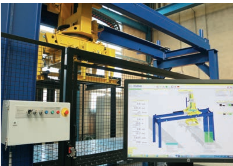
Рис. 9: Опытная установка показала среднее тактовое время 9,6 с
