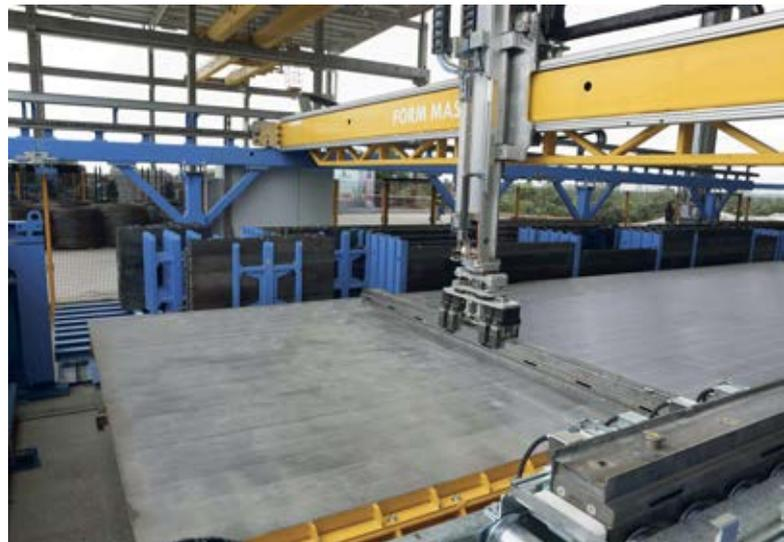
*Процессы опалубки и распалубки также были автоматизированы. Это повышает не только качество конечного продукта и скорость производства, но и безопасность труда*
