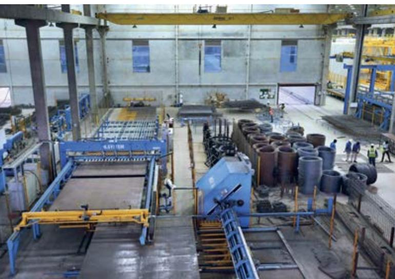
*Три высокоэффективные арматурные установки (по центру видна сеткосварочная установка) обеспечивают непрерывный производственный процесс*
