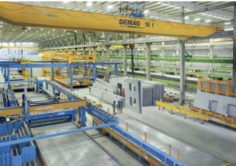
*Высокая скорость и безупречное качество: новая автоматизированная циркуляционная линия позволяет компании KEF Infra выпустать различные стеновые элементы*
