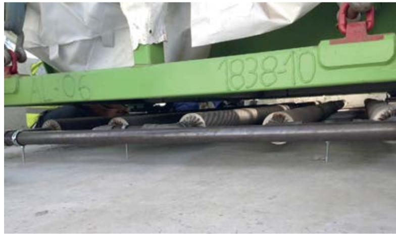
*Под опалубкой расположены гофрированные трубы, которые генерируют тепло излучения мощностью 600 Вт на один метр и при необходимости способны контролировать температуру опалубки до 60°C*
