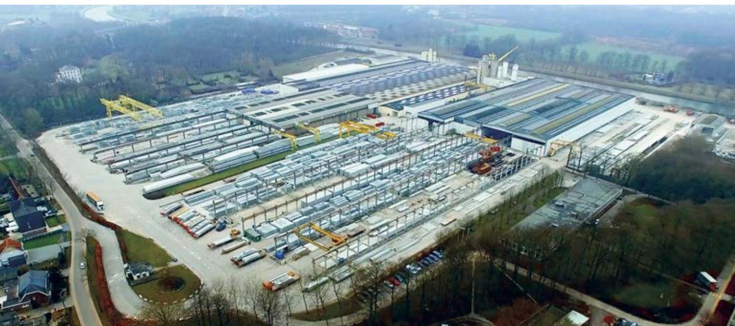
В крытых заводских цехах Ergon общей площадью 49 000 м<sup>2</sup> изготавливаются конструктивные ЖБИ, стеновые элементы и преднапряженные бетонные перекрытия. Общая площадь предприятия, основанного в 1963 году, составляет 240 000 м<sup>2</sup>
