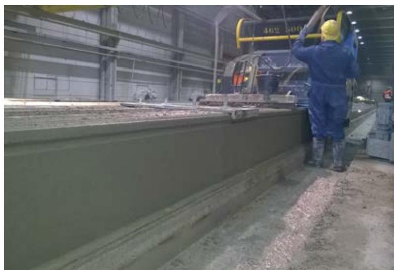
Помимо преднапряженных перекрытий высотой 26,5 см и 40 см, теперь можно изготавливать элементы высотой 50 см
