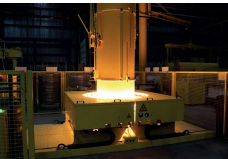
Термопластическое формование раструба
