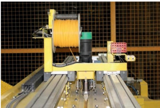
При помощи сварочного робота выполняется сварной шов сварочной проволокой, которая надежно соединяет оба края футеровки
