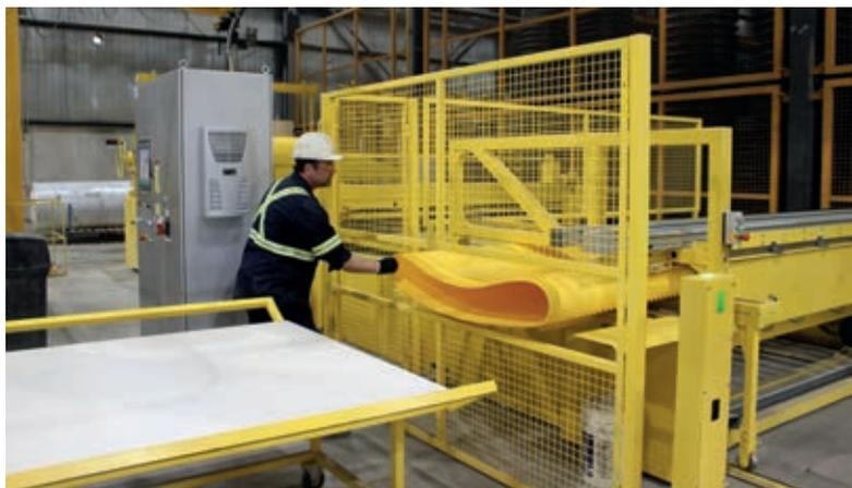
Готовая футеровка снимается со сварочного аппарата сотрудником
