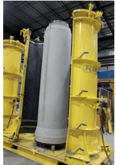
Затвердевшая композитная труба Perfect Pipe
