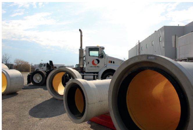
Rury betonowe z wykładziną HDPE Perfect Pipe - wystawa pokazowa przed zakładem.
