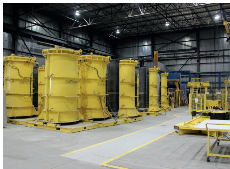
Hala produkcyjna z formami Perfect Pipe.
