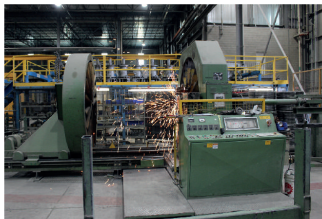
Jedna z dwóch maszyn do koszy zbrojeniowych produkcji MBK.
