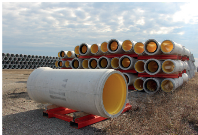
Con Cast Pipe skonstruował specjalne ramy do magazynowania i transportowania rur.
