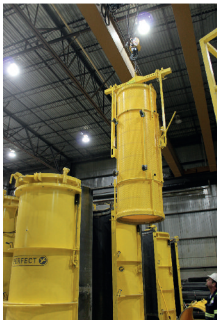
Uformowane cylindry (z pierścieniami) transportowane są w klatkach i mocowane na rdzeniach kurczliwych w formach.
