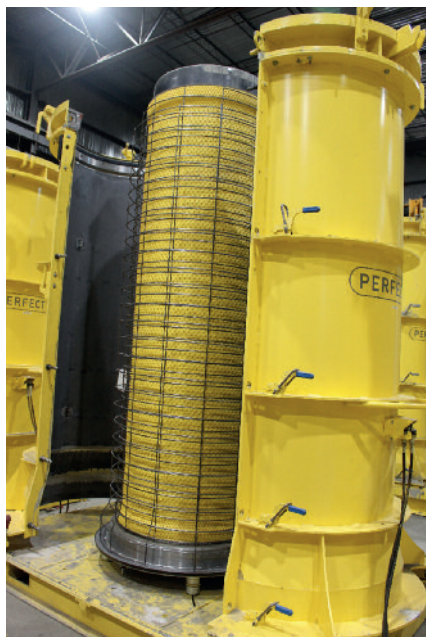
Forma uzbrojona w wykładzinę oraz kosz zbrojeniowy.
