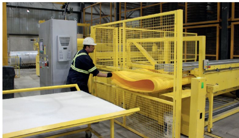
Zespawana wykładzina odbierana jest przez operatora.
