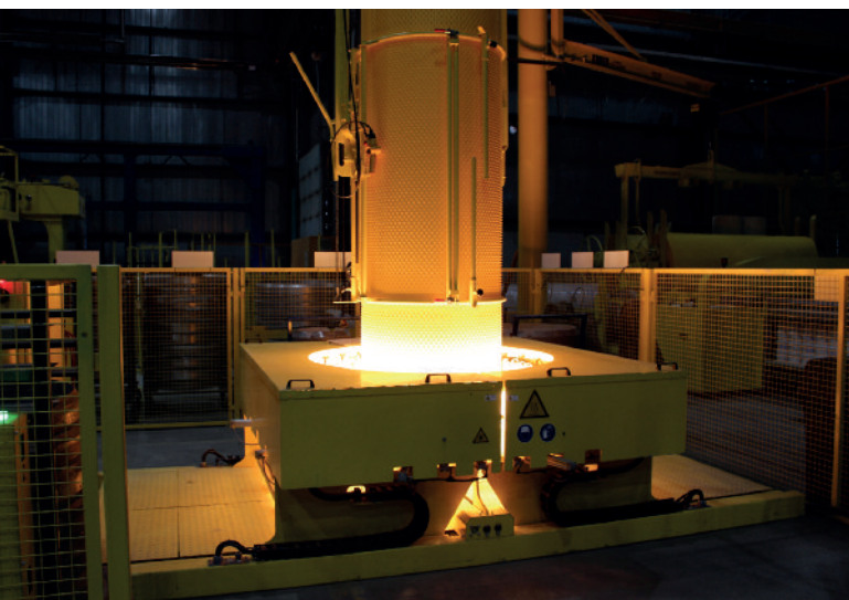
Kształtowanie wykładziny w miejscach połączeń rurowych w stacji formowania.
