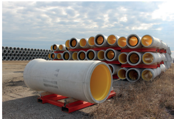
Per il magazzino e il trasporto successivo in cantiere Con Cast Pipe ha costruito speciali impalcature, sui quali vengono conservati i tubi.
