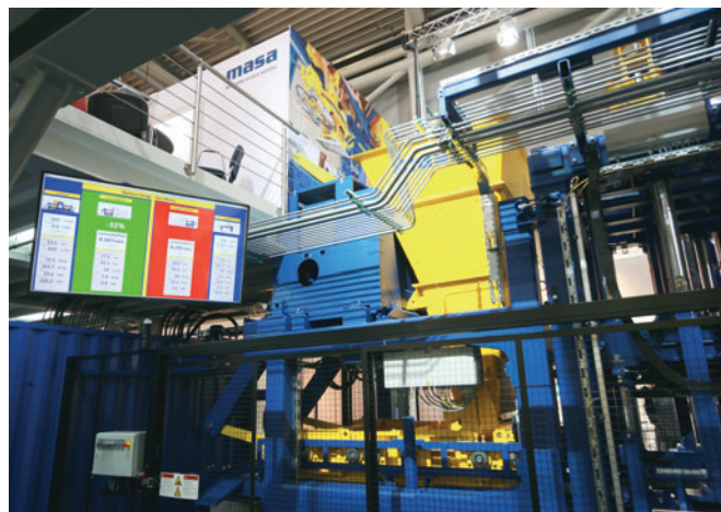
Fig. 3: Il monitoraggio dell'efficienza energetica della blocciera Masa XL al salone bauma 2016
