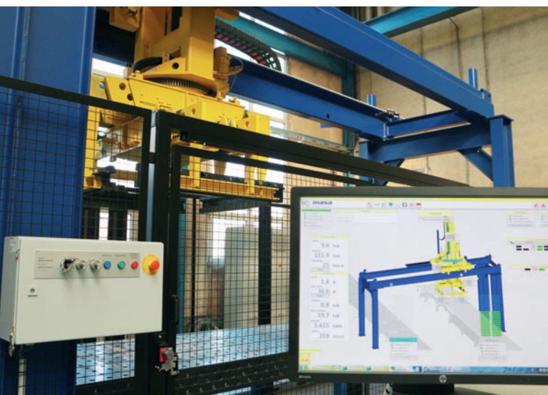
Fig. 9: Nella struttura sperimentale è stato realizzato un tempo di ciclo di 9,6 secondi
