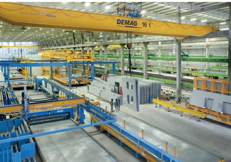
*Velocemente e qualitativamente: l'impianto a carosello di pallet, altamente automatizzato, di recente installazione, consente a KEF Infra di realizzare diversi elementi di parete.*
