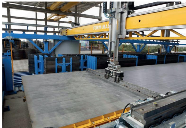
*Anche le operazioni di posizionamento e rimozione delle sponde sono state automatizzate. Ciò consente non solo di migliorare la qualità dei prodotti finiti e di aumentare la velocità di produzione, ma anche di migliorare la sicurezza sul lavoro.*
