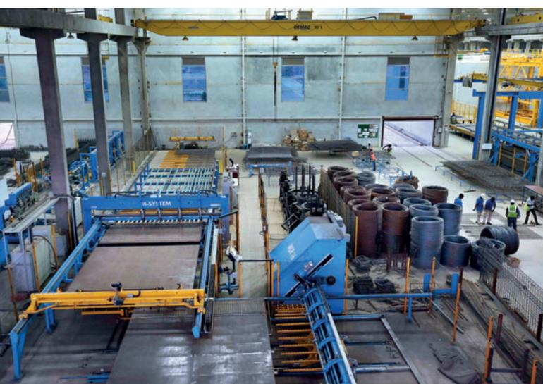
*I tre impianti installati per la produzione d'armatura (nella foto l'impianto di saldatura reti) contribuiscono a un'ottima continuità di produzione grazie alla loro efficienza.*
