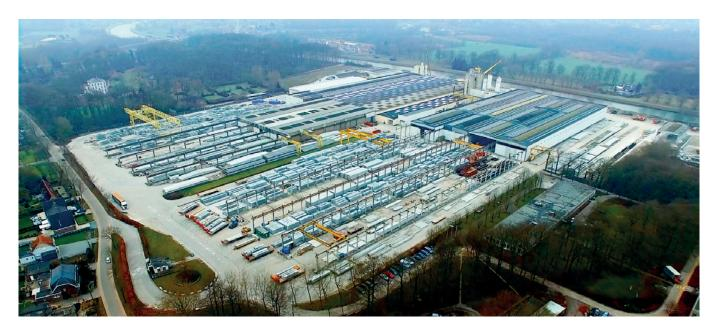
Nei capannoni di produzione della Ergon su una superficie complessiva di 49.000 m² si producono elementi prefabbricati strutturali, elementi per pareti e solai alveolari. L'intera area dello stabilimento della società costituita nel 1963 occupa una superficie di 240.000 m².
