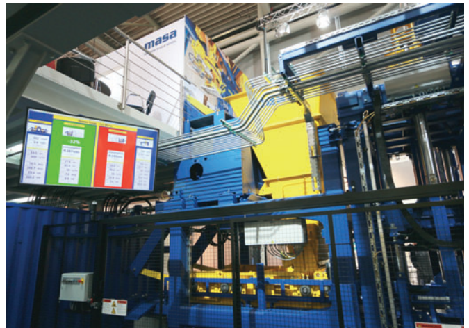
Fig. 3 : Surveillance de l'efficacité énergétique d'une installation de production de blocs en béton Masa XL au bauma 2016
