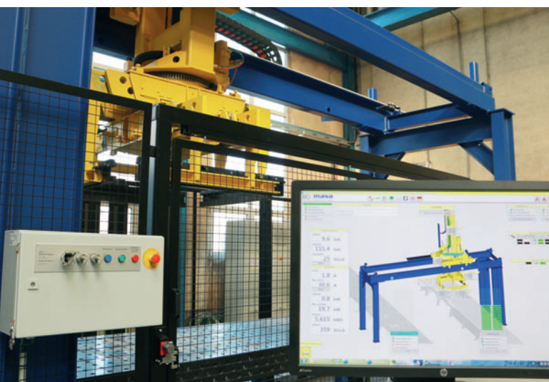
Fig. 9 : Un temps de cycle de 9,6 secondes a été réalisé avec l'arrangement expérimental
