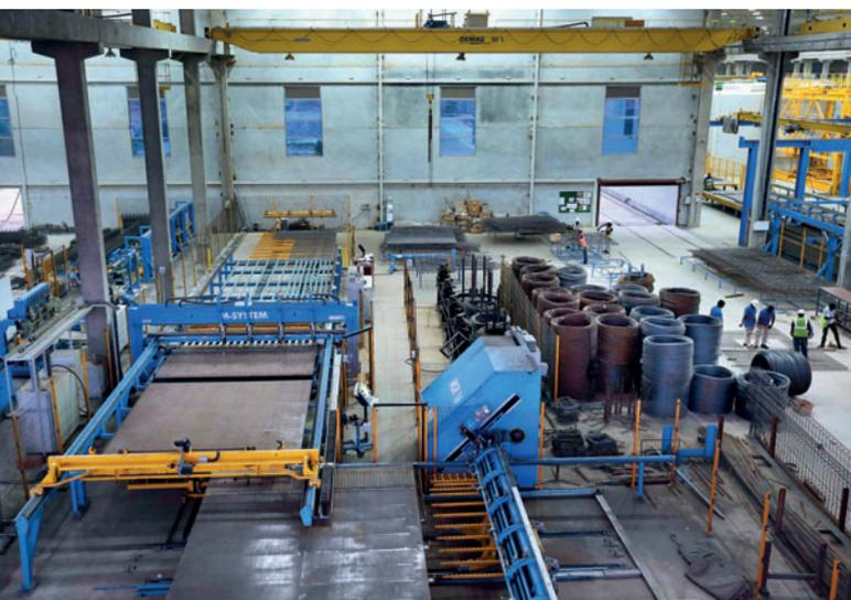
*Les trois installations destinées à la fabrication d'armatures (sur la photo, une installation de soudage de treillis) assurent une très bonne continuité de la production, grâce à leur efficacité.*
