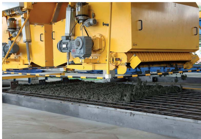
*Un distributeur de béton automatique apporte le béton frais de manière ciblée sur une palette et le répartit uniformément.*
