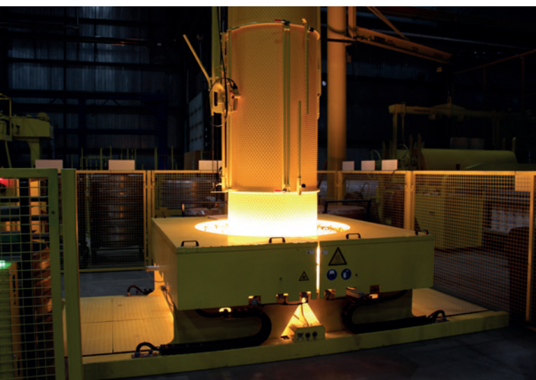
Formation des manchons dans le poste de façonnage
