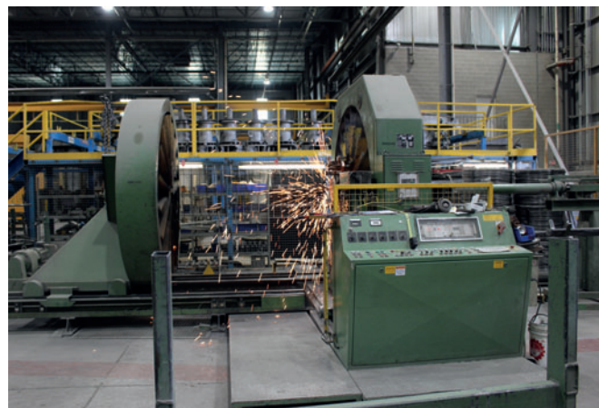
L'une des deux installations MBK pour la fabrication d'armatures, à Oakville
