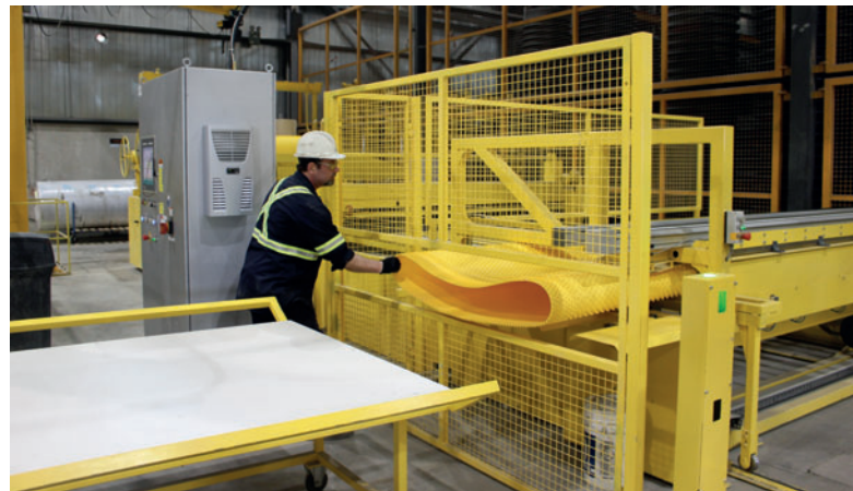
Le PEHD soudé est éjecté de la machine à souder et récupéré par un collaborateur
