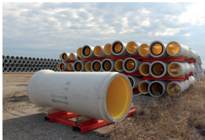
Pour le stockage et le transport ultérieur vers le chantier Con Cast Pipe a conçu une construction spéciale sur laquelle les tuyaux peuvent être déposés
