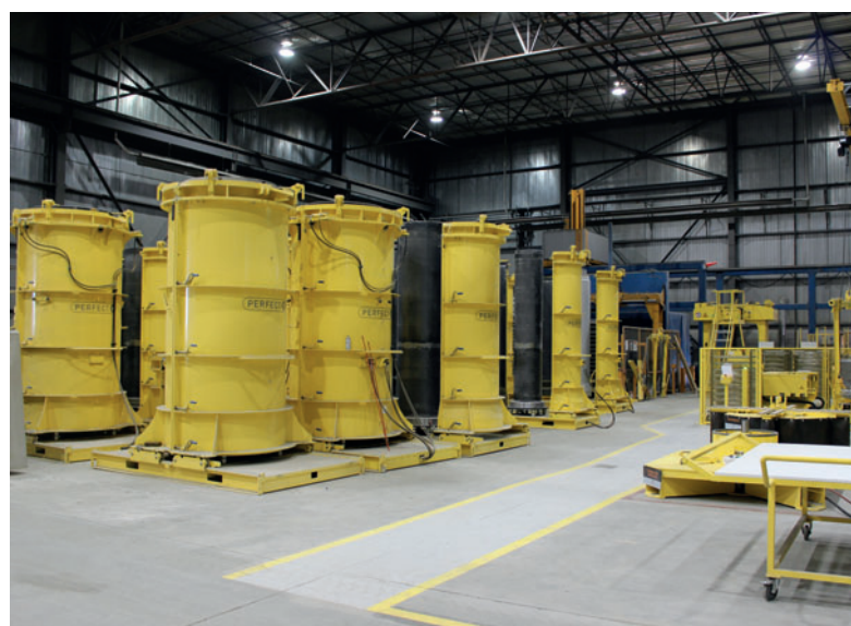
Parc de moules de l'usine Con Cast Pipe de tuyaux Perfect
