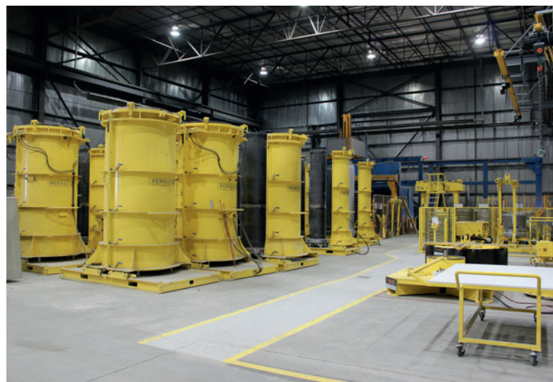
Estación de moldes de la fábrica Perfect Pipe de Con Cast Pipe
