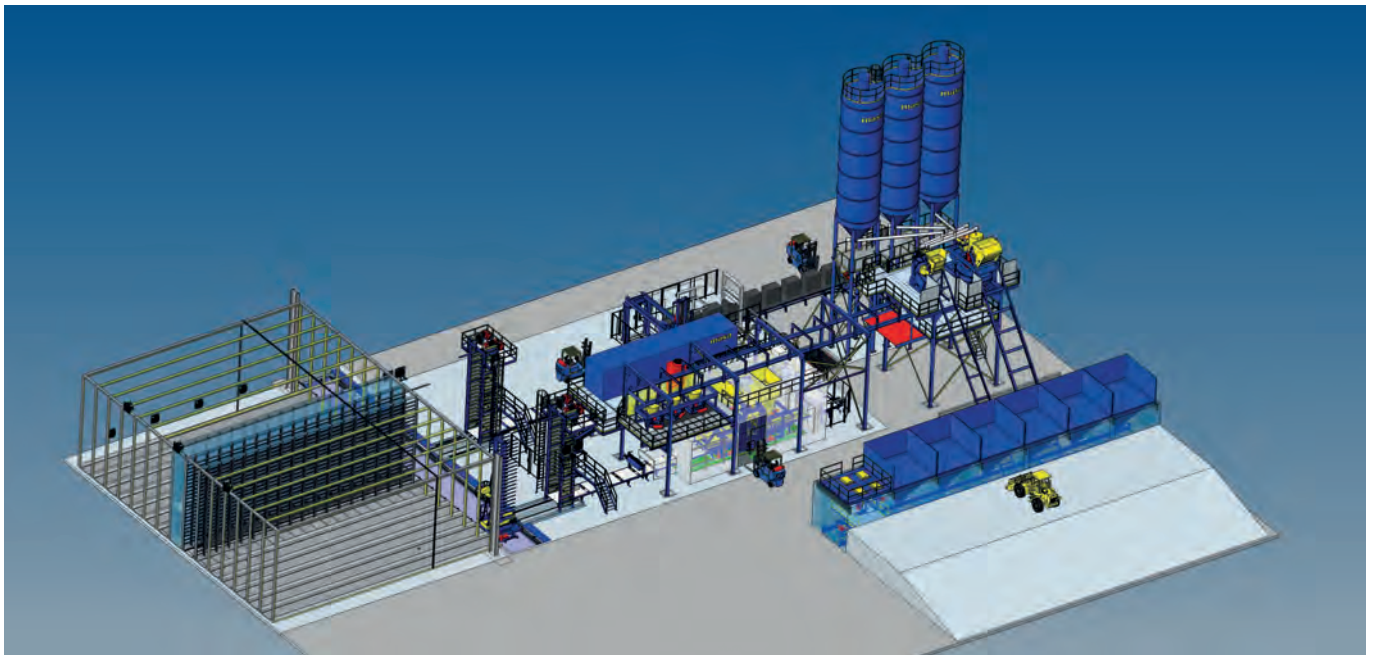
Abb. 4: Masa-Anlagendesign: Optimierte Energieeffizienz durch kurze Wege bei der Energieverteilung
