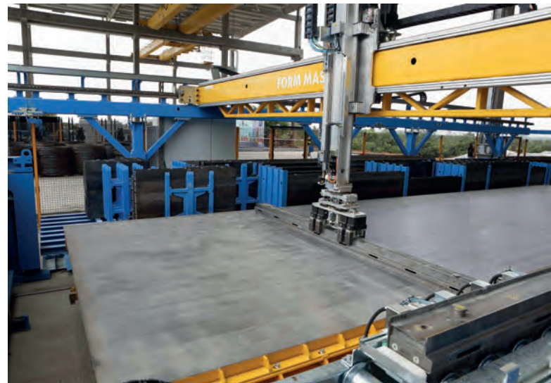
Auch das Schalen und Entschalen wurde automatisiert. Damit erhöhen sich nicht nur die Qualität der Endprodukte und die Produktionsgeschwindigkeit, sondern auch die Arbeitssicherheit.
