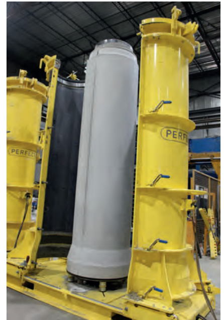
Ausgehärtetes Perfect Pipe Verbundrohr
