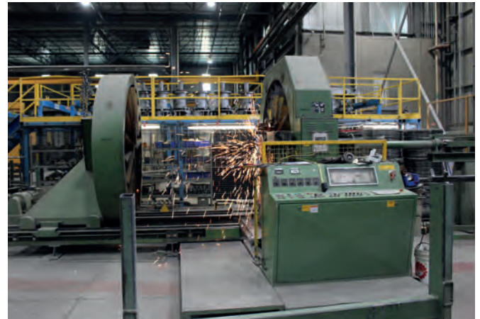
Eine der beiden mbk Korbschweißanlagen, die in Oakville im Einsatz sind
