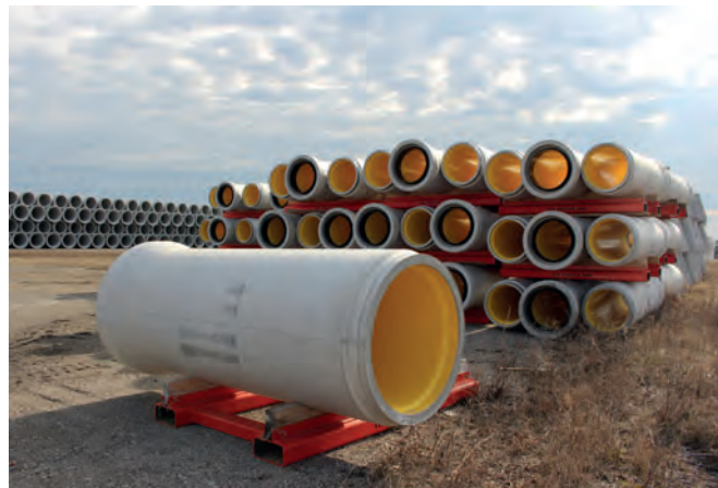
Für die Lagerung und den späteren Transport zur Baustelle hat Con Cast Pipe spezielle Hilfsgerüste gebaut, auf denen die Rohre lagern.
