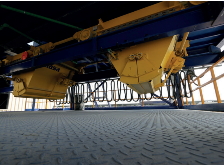
Les bétons de parement et de corps sont transportés vers les silos de l'installation de production de blocs en béton par le biais d'un convoyeur à bennes Masa
