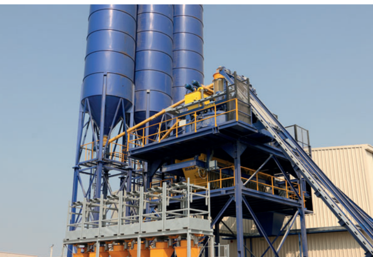
Tour de malaxage Masa : le convoyeur à bennes Masa se trouve sous le mélangeur de béton
