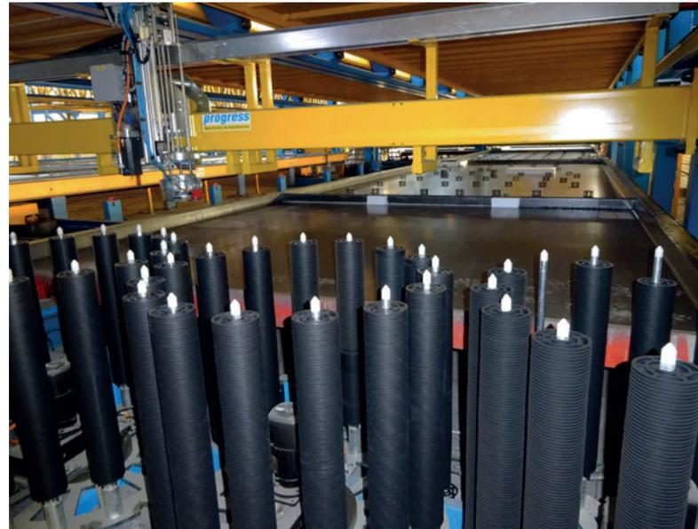
Dos robots denominados Mesh Spacer colocan distanciadores especiales para las mallas de armadura de forma completamente automática y según los datos CAD-CAM.
