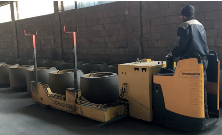
Produkt wird mit Abfahrwagen in den Aushärtbereich transportiert
