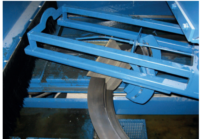
Muffenölung via Schwamm und damit ohne Sprühnebel
