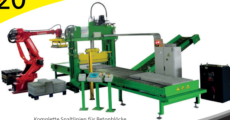
Komplette Spaltlinien für Betonblöcke
