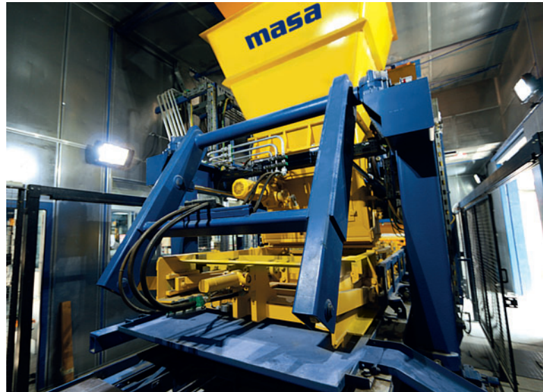
Herzstück der neuen Anlage: Masa Betonsteinfertigungsmaschine XL 9.1
