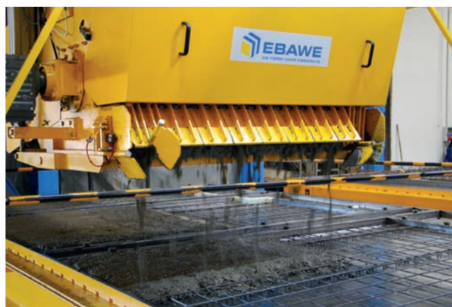
全自动混凝土布料机确保新拌混凝土准确、均匀地卸料
