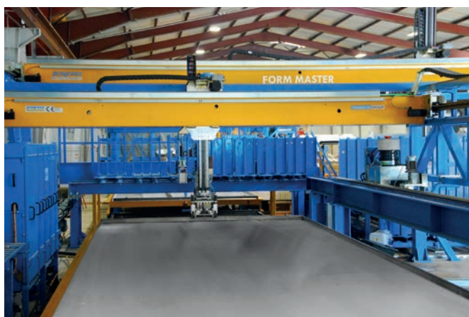
置模和脱模机械手在提高效率和质量方面起着关键作用：Form Master 可以全自动、高精度地执行所有工序
