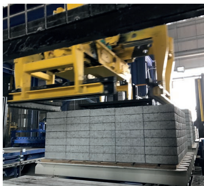
运用 Masa Cuboter 使得完整的砌块层组装成石制立方体
