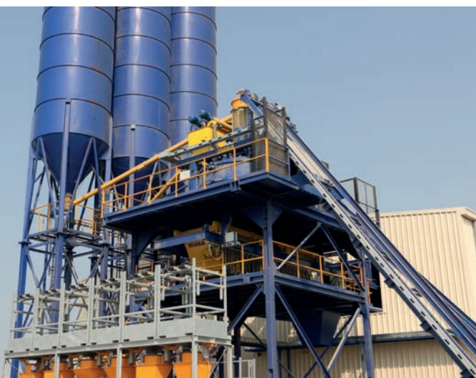
Masa 搅拌塔：在混凝土搅拌机下方，您会看到 Masa 双料斗输送机
