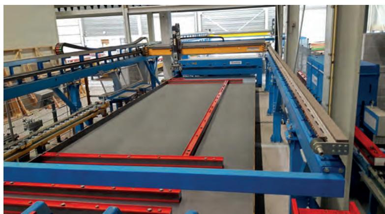
Одним из ключевых компонентов линии циркуляции паллет является опалубочно-распалубочный робот Form Master. Полностью автоматизированные технологические процессы обеспечивают гибкое и оперативное производство
